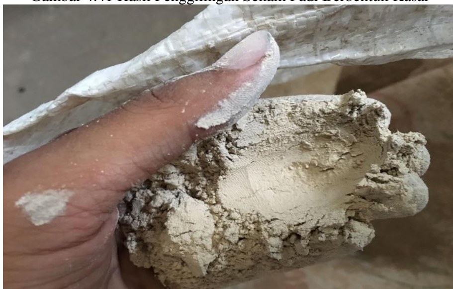
Gambar 4.42 Hasil Penggilingan Sekam Padi Berbentuk Halus
