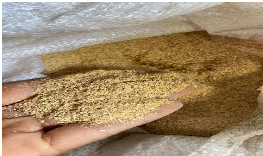
Gambar 4.41 Hasil Penggilingan Sekam Padi Berbentuk Kasar
