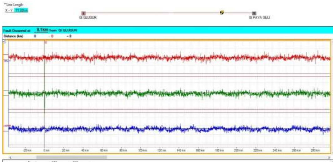
Gambar Signal Gelombang Gangguan Pada Jarak 8,1 km
