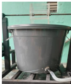
Gambar 3.2 Turbin Air dirancang dari Akrilit
