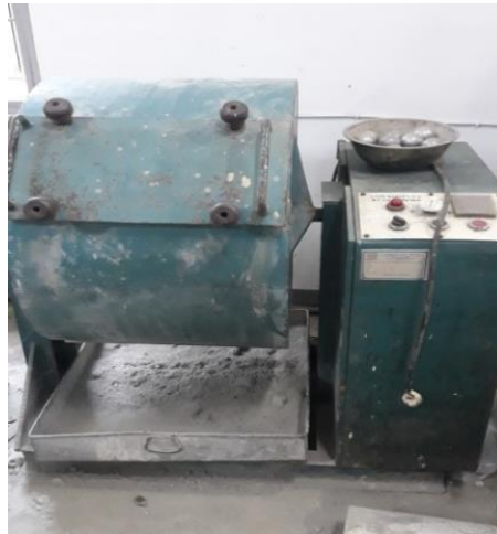
Gambar 3.23: Mesin Los Aangeles .
