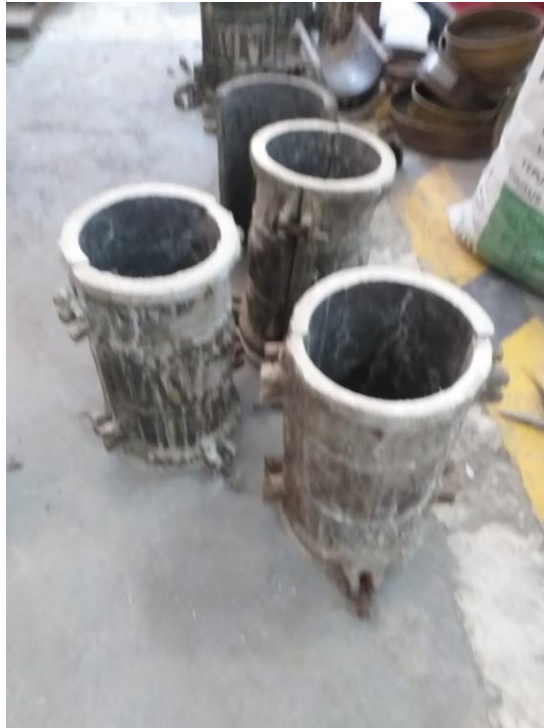
Gambar L7: Dokumentasi cetakan silinder
