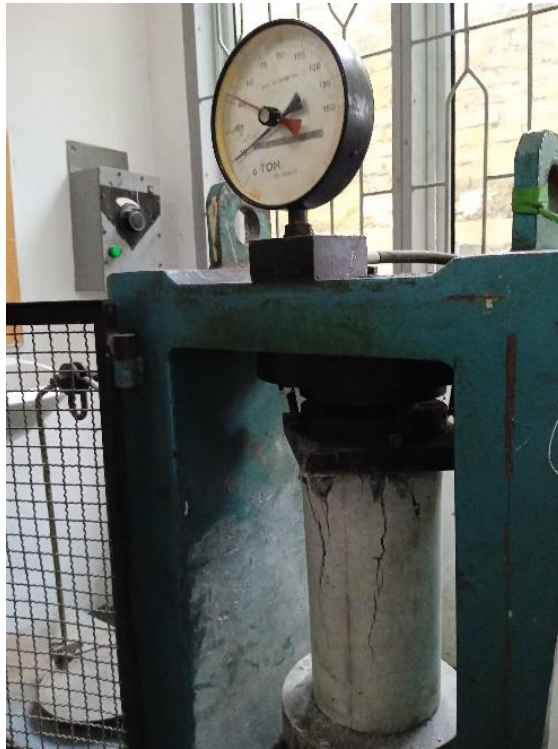
Gambar L13: Dokumentasi proses pengujian kuat tekan beton
