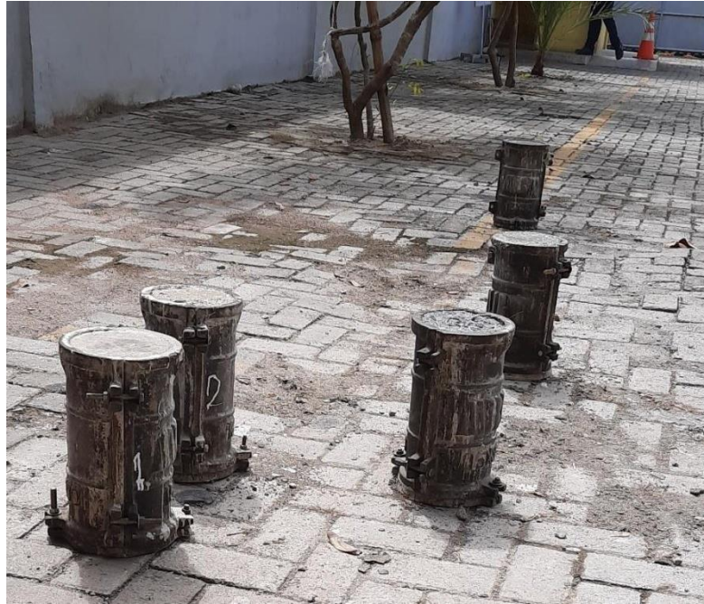
Gambar L11 : Dokumentasi proses perawatan beton (penjemuran)
