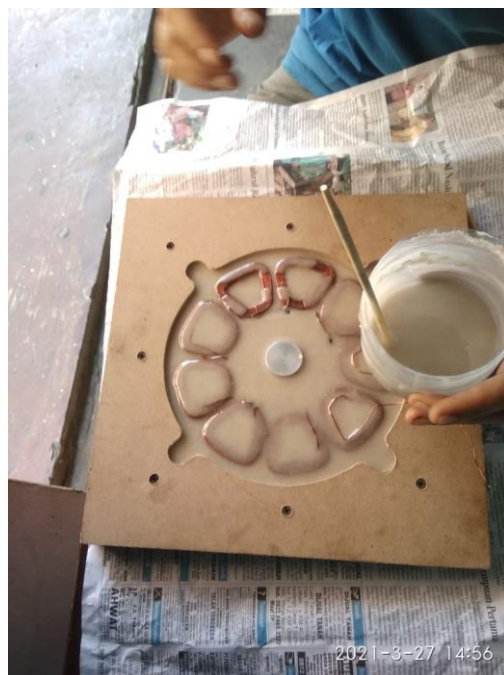
Gambar Proses Pembuatan Stator Dengan Menggunakan Campuran Resin, Katalis Dan Serat Kaca
