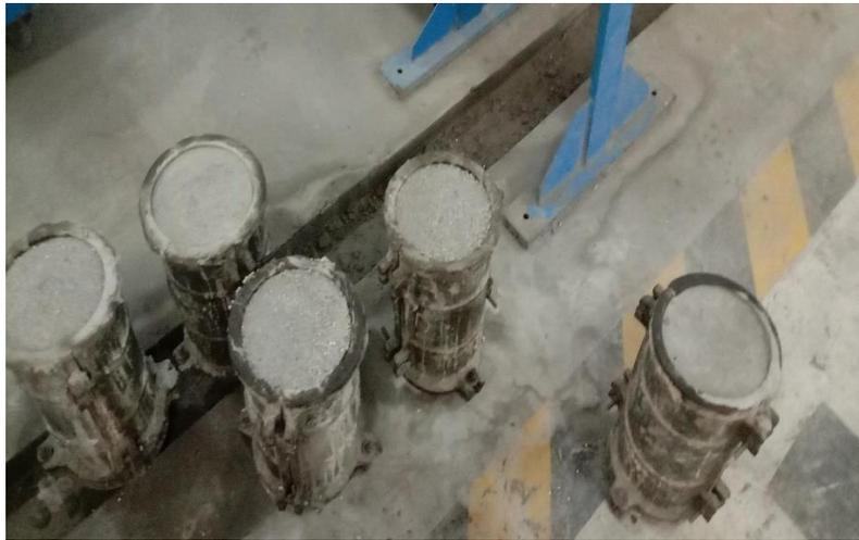
Gambar L.14: Pengeringan beton ringan dalam cetakan
