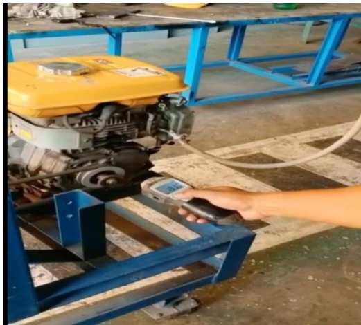
Gambar 2.29. Mengukur Rotasi Mesin Menggunakan Tachometer
