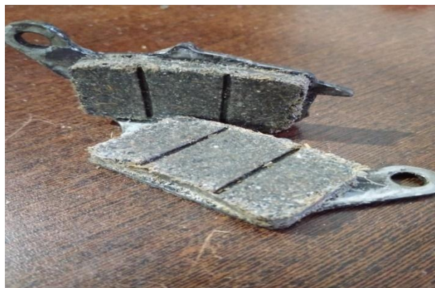
Gambar 2.25. Kampas Rem Selesai Proses Kompaksi
