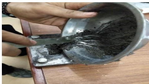
Gambar 3.23. Meratakan Adonan Pada Cetakan
