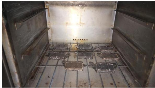
Gambar 3.26 Proses sintering atau pemanasan
