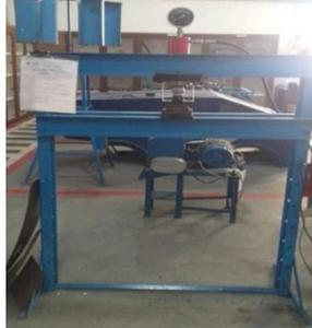
Gambar 3.1.Mesin Press Hidraulik
