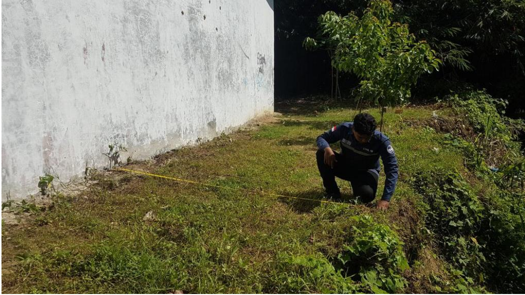
Gambar L.3: Mengukur jarak dari bangunan ke longsor
