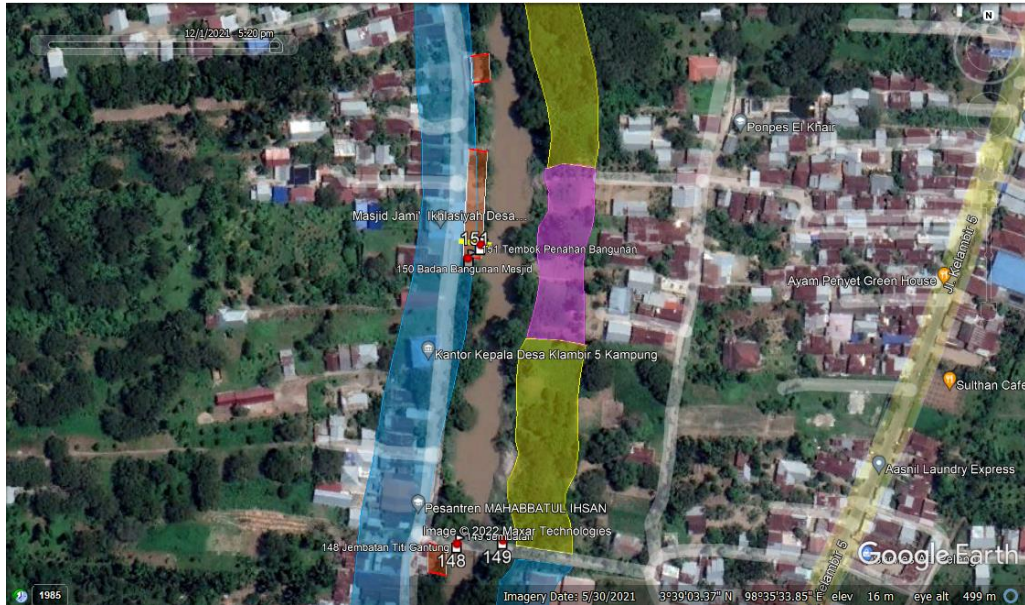
Gambar 4.18: Lokasi bangunan melewati batas garis sempadan
