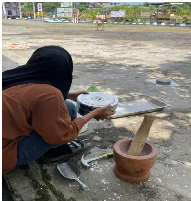
Gambar L8: Proses penyaringan agregat.
