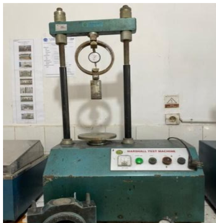
Gambar 2.2: Alat pengujian marshall (Laboratorium PT. Adhi Karya).
