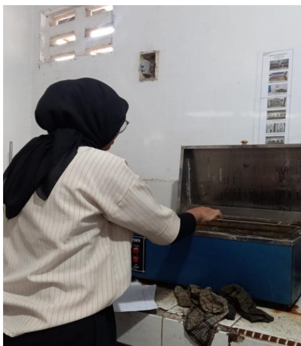
Gambar L11: Proses perendaman benda uji di waterbath .
