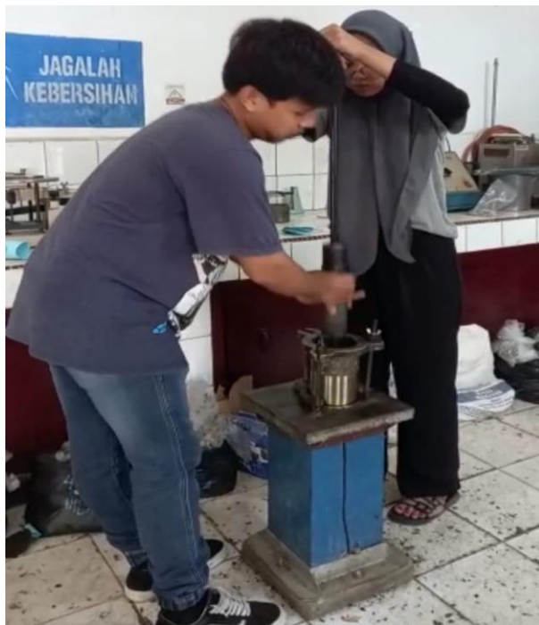
Gambar L10: Proses penumbukan benda uji.
