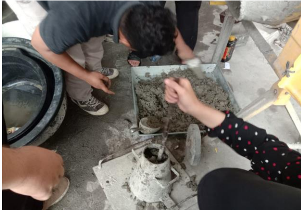
Lampiran 28: Proses perojokan adukan beton.
