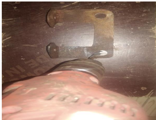
Gambar 4.8 Pengeboran lubang dudukan kaliper
