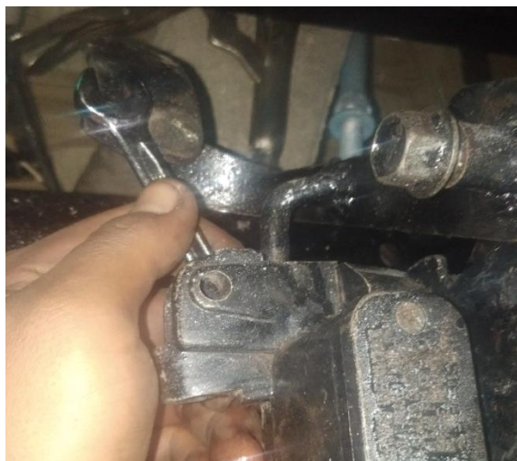
Gambar 4.30 Pemasangan master rem
