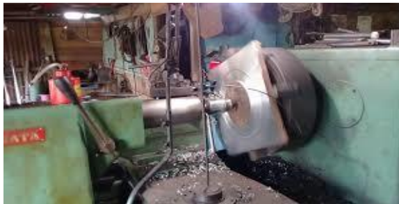
Gambar 4.4 Pembubutan piringan cakram
