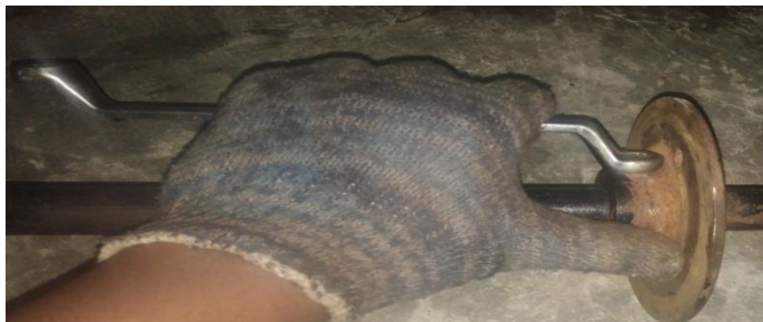
Gambar 4.25 Pemasangan Piringan cakram dengan poros roda
