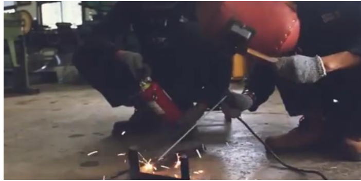
Gambar 4.17. Penyambungan pembuatan pedal rem menggunakan mesin las Setelah melakukan proses penyambungan maka di dapatlah hasil dari pedal rem yang sudah dibuat dari beberapa proses. lihat pada gambar 4.18 dibawah ini
