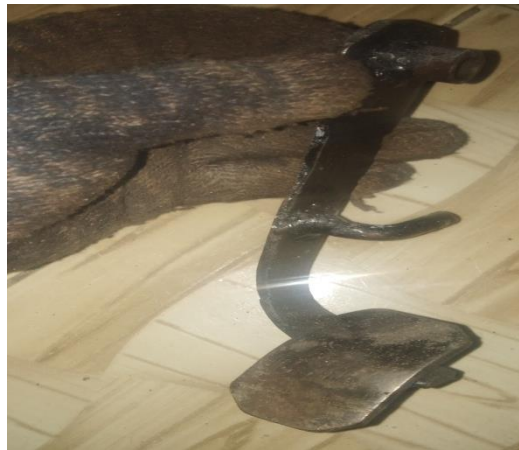
Gambar 4.18 Pedal Rem yang sudah selesai dibuat
