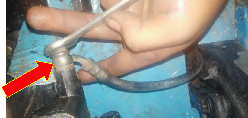
Gambar 4.29 Pemasangan selang rem
