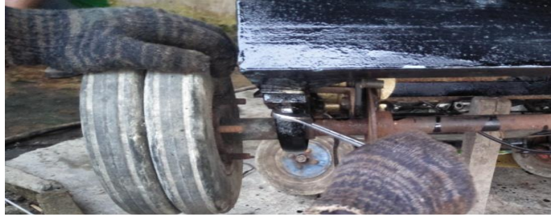
Gambar 4.26 Pemasangan poros roda
