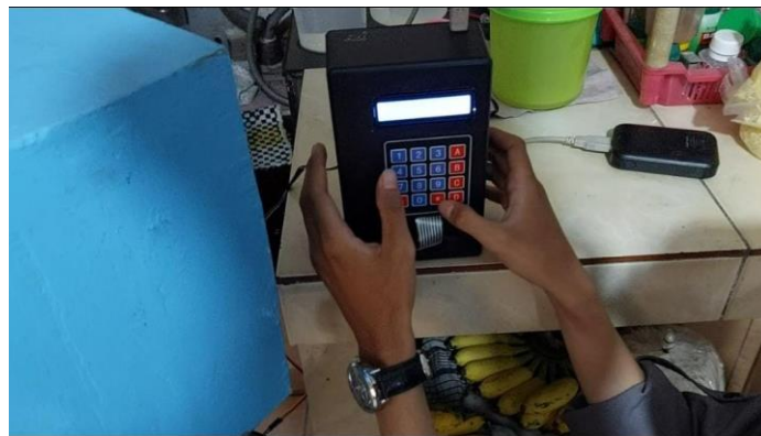
Gambar 4.14. Pengujian keypad Gilbarco 4x4 pada mixer
