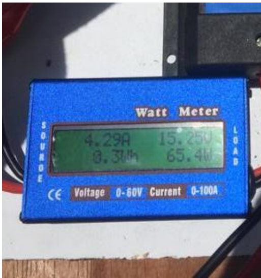
Gambar 4. Pengambilan Data Arus Dan Tegangan Pada Wattmeter
