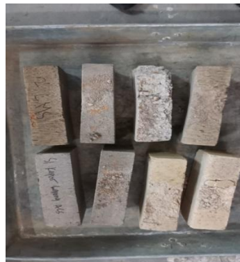
Gambar -21 Setelah Di Uji Kuat Tekan Batu Bata
