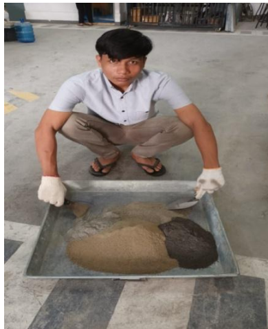
Gambar -18 Bata Variasi Campuran Semen + Tanah Galong + Pasir + ACS
