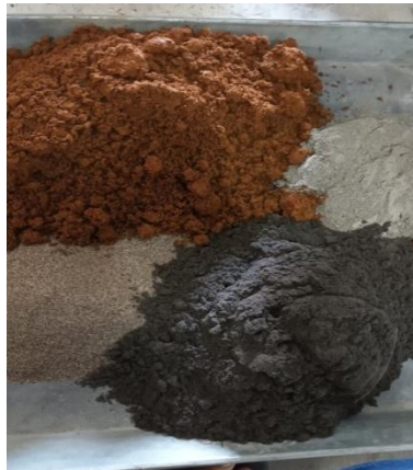
Gambar -17 Bata Variasi Campuran Semen + Tanah Merah + Pasir + ACS
