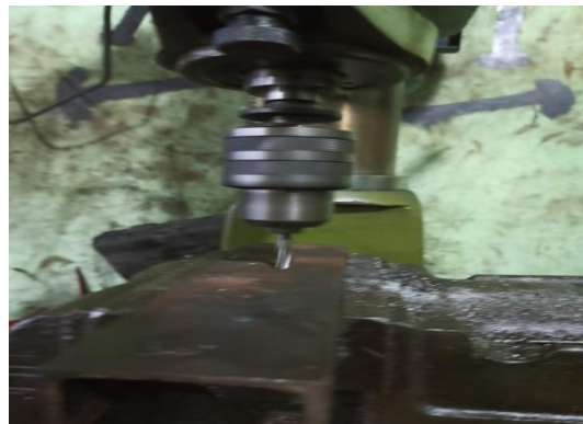
Gambar 4.10 Proses Pembuatan Lubang Pengunci Motor
