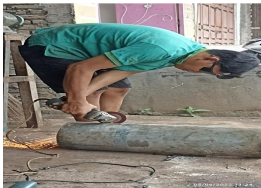
Gambar 4.33 Pemotongan Besi Tabung untuk Tutup mata pisau
