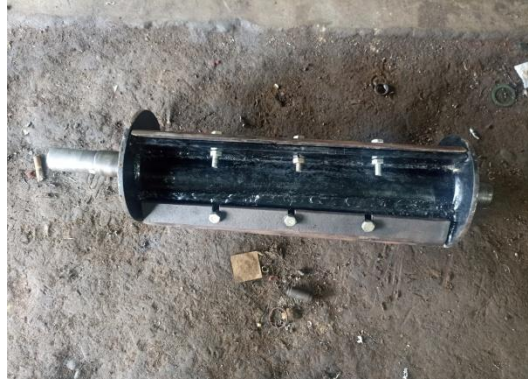
Gambar 4.28 Mata Pisau Yang Sudah di sambungkan ke Poros
