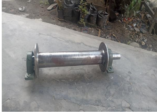
Gambar 4.20 Pemasangan Bearing Pada Poros
