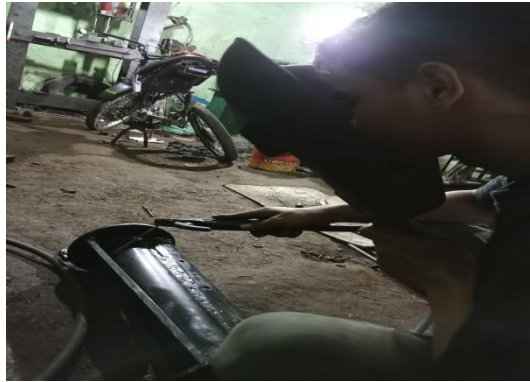
Gambar 4.25 Proses Pengelasan Dudukan Mata Pisau
