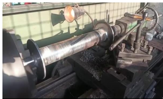
Gambar 4.19 Proses Pembubutan Poros
