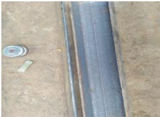
Gambar 4.9 Baja UNP dudukan Motor
