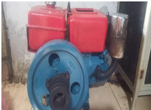
Gambar 3. 8 Mesin Penggerak Dompok R175 7HP
