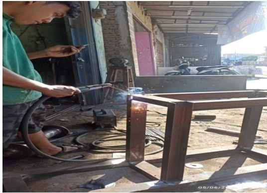
Gambar 4.11 Proses Pengelasan Rangka
