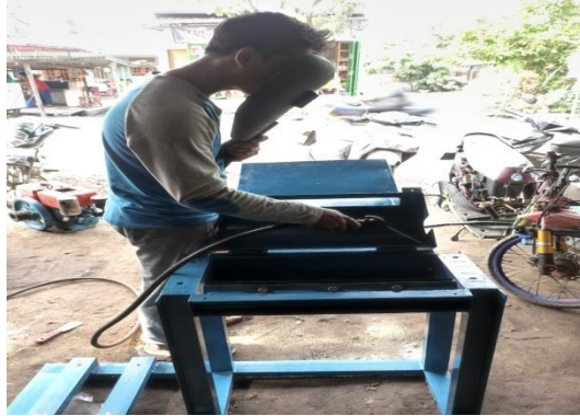
Gambar 4.35 Pengelasan Penutup Mata Pisau
