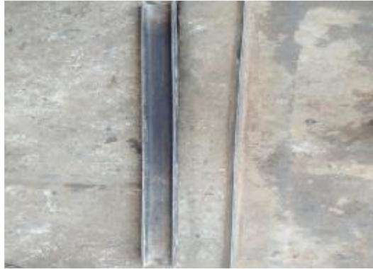
Gambar 4.5 Baja UNP Sebagai Konstruksi Rangka
