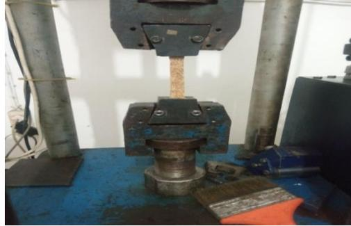
Gambar 3.22 Pemasangan Spesimen Uji Tarik
