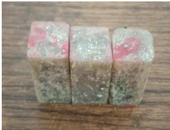
Gambar 4.13 Spesimen Pengujian Tekan 80% Resin 20% Komposit
