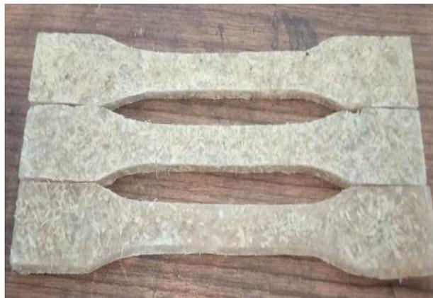
Gambar 4.4 Spesimen Pengujian Tarik 90% Resin 10% Komposit
