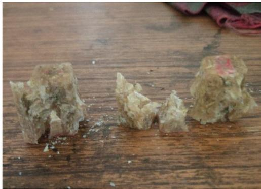
Gambar 4.16 Hasil Pengujian Tekan 80% Resin 20% Komposit
