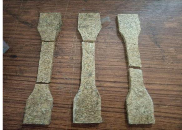
Gambar 4. 5 Hasil Pengujian Tarik 70% Resin 30% Komposit
