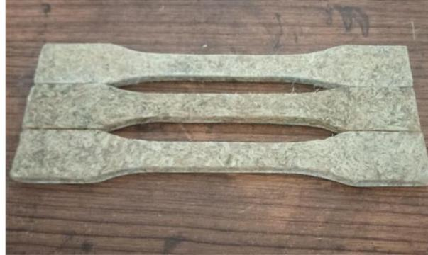
Gambar 4.2 Spesimen Pengujian Tarik 70% Resin 30% Komposit
