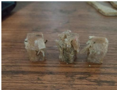
Gambar 4.17 Hasil Pengujian tekan 90% Resin 10% Komposit
