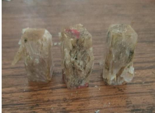
Gambar 4.15 Hasil pengujian Tekan 70% Resin 30% Komposit
