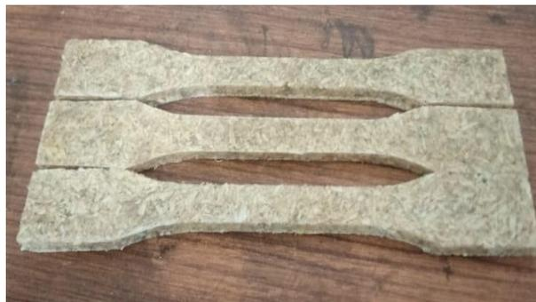
Gambar 4.3 Spesimen Pengujian Tarik 80% Resin 20% Komposit
