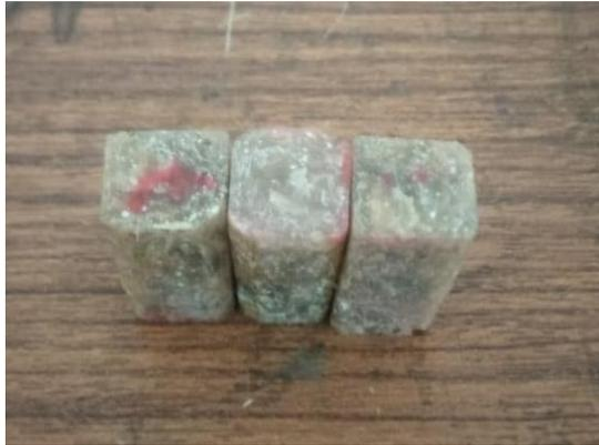
Gambar 4.12 Spesimen pengujian Tekan 70% Resin 30% Komposit
