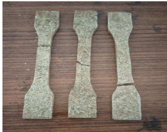
Gambar 4. 6 Hasil Pengujian Tarik 80% Resin 20% Komposit
