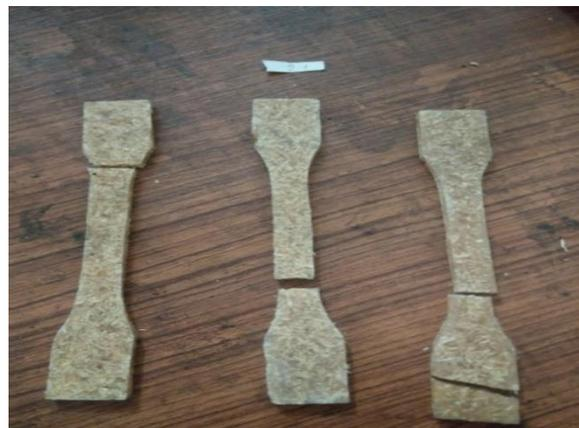
Gambar 4. 7 Hasil Pengujian Tarik 90% Resin 10% Komposit
