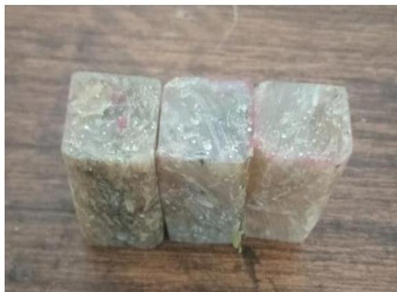
Gambar 4.14 SpesimenPengujian tekan 90% Resin 10% Komposit
