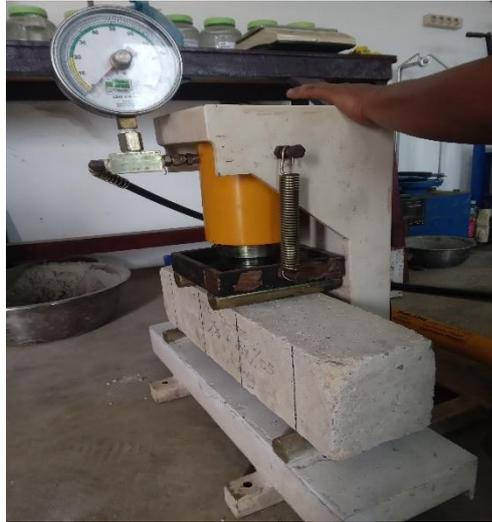
Gambar 3.11: Pengujian kuat lentur beton.
