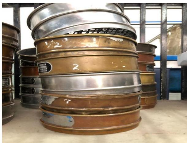
Gambar L-8: Saringan agregat kasar.
