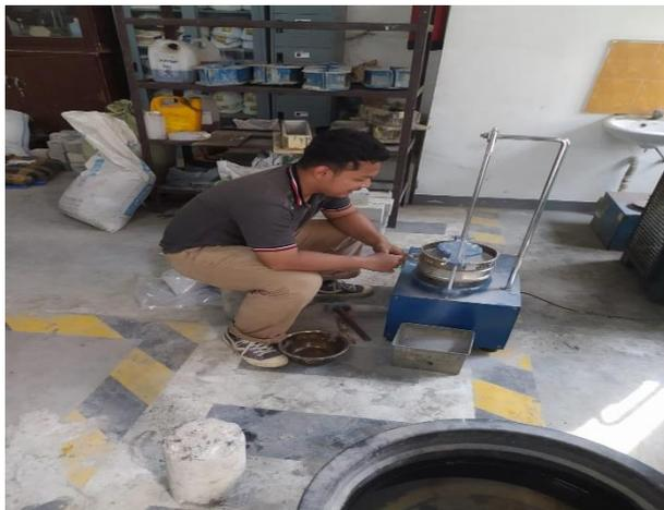
Gambar L-21: Mesin ayakan (Sieve Shaker).
