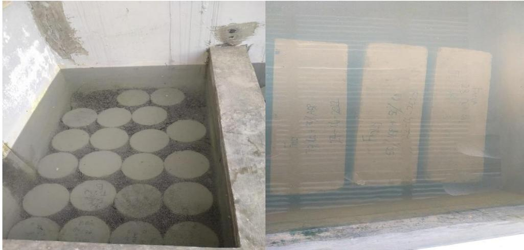
Gambar 3.9: Perawatan benda uji beton berbentuk silinder dan balok.
