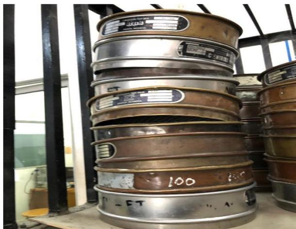
Gambar L-7: Saringan agregat halus.
