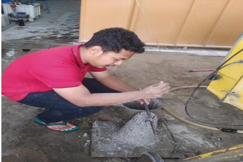
Gambar 3.8: Pengujian *slump*.
