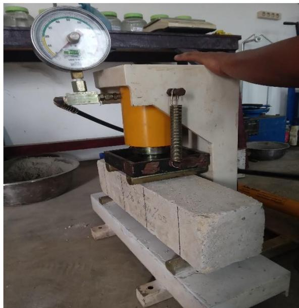
Gambar L-29: Proses pengujian kuat lentur beton
