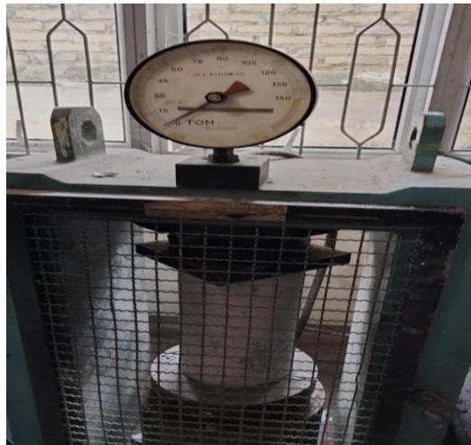
Gambar 3.10: Pengujian kuat tekan beton.
