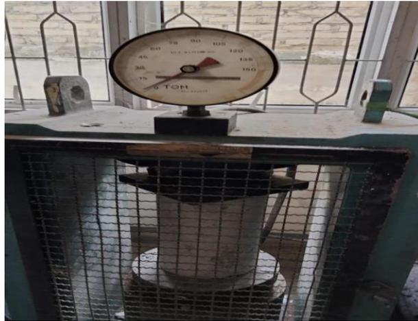
Gambar L-28: Proses pengujian kuat tekan beton.
