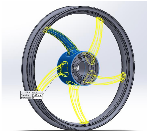
Gambar 4.7 Membuat jumlah spoke pada velg
