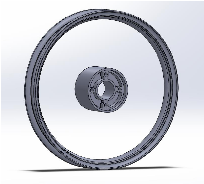
Gambar 4.4 Desain bagian tengah velg
