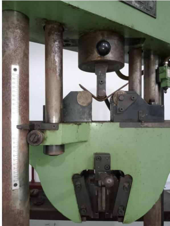
Gambar 3.13 Proses Bendung pada Spesimen *Bending*
