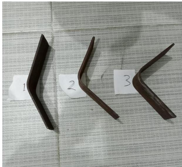
Gambar 4.9 Spesimen Besi sesudah dibending
