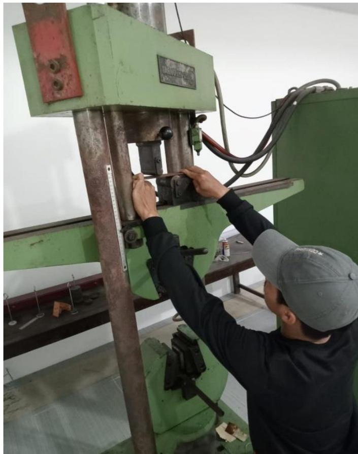
Gambar 3.12 Proses Pemasangan Spesimen bending
