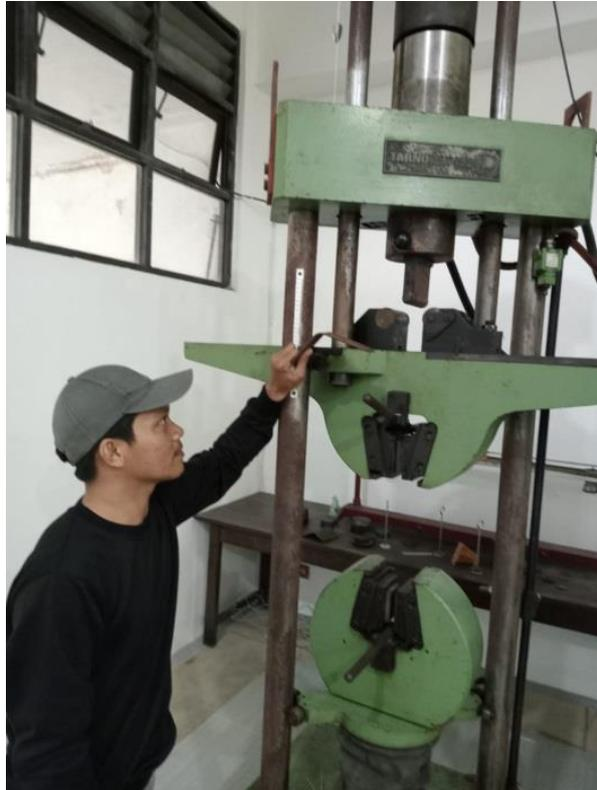
Gambar 3.14 Proses Pelepasan Spesimen Tekan
