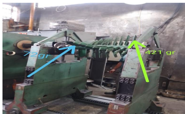
Gambar 4.3. titik penambahan massbalance
