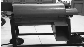
Gambar 3.2. Mesin pencacah sampah organik (sumber :pengolah sampah.com)
