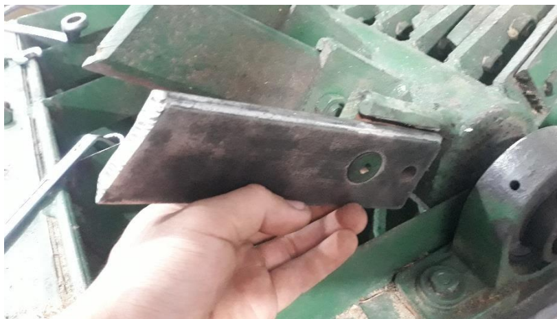
Gambar 4.22. Pemasangan mata pisau
