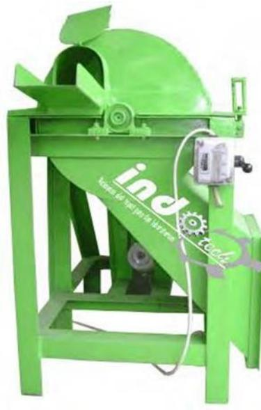
Gambar: 2.1 Mesin pencacah rumput gajah ( Sumber : <http://www.mesin-industri.com/>)
