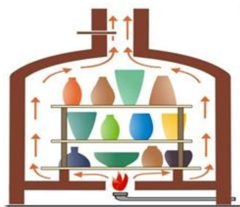
Gambar 2.1. Tungku Dengan Sirkulasi Api Naik.
