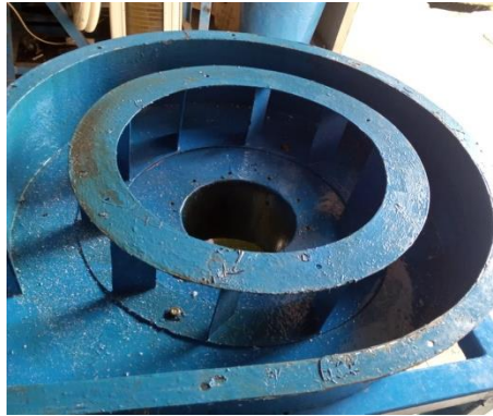
Gambar 4. 23 Pemasangan penyearah tetap
