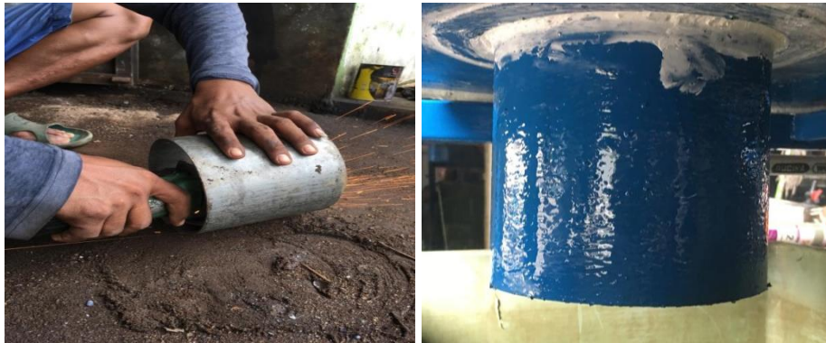
Gambar 4. 3 Pembuatan pipa hisap
