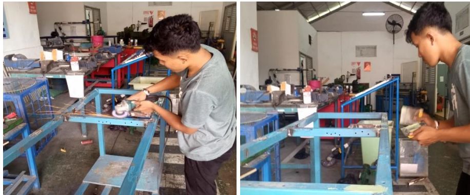
Gambar 4. 20 Proses penggerindaan dan pendempulan meja turbin
