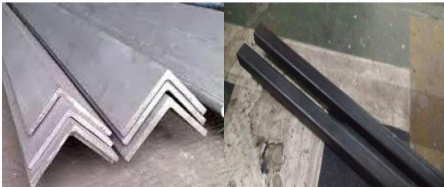
Gambar 3. 4 Besi Hollow dan Besi Siku
