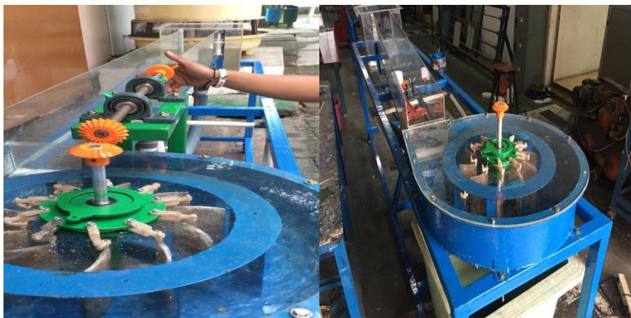
Gambar 4. 32 Hasil pemasangan turbin kaplan
