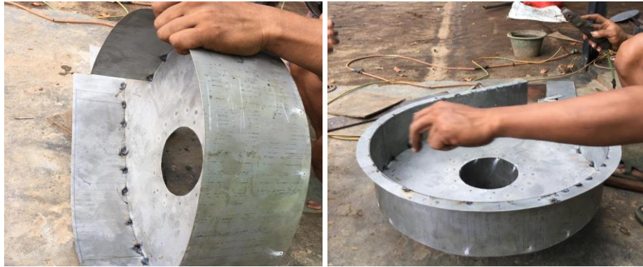
Gambar 4. 5 Proses pengelasan rumah turbin
