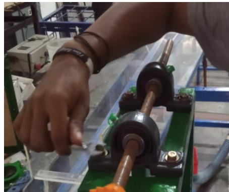
Gambar 4. 29 Pemasanganudukan bearing shaft
