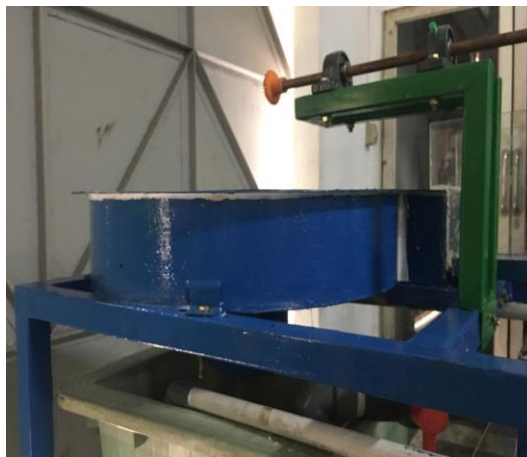
Gambar 4.32 Letakan Rumah Turbin Ke Rangka
