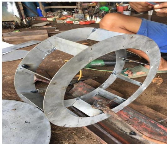
Gambar 4.26 Plat Yang Disatukan Dengan Las
