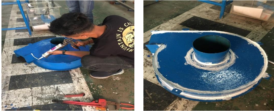
Gambar 4.31 Silicone Rumah Turbin.
