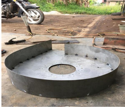
Gambar 4.8 Plat Tinggi Dan Lebar Rumah Turbin Disatukan
