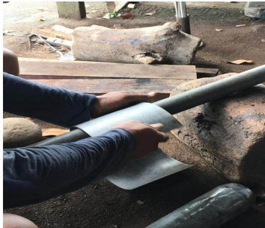
Gambar 4.15 Membentuk Plat Untuk Bulat
