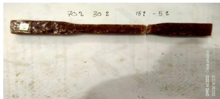
Gambar 4.11. Spesimen sesudah pengujian uji tarik komposit Resin 70:30, Serat sabut kelapa : serbuk kayu (15:5)
