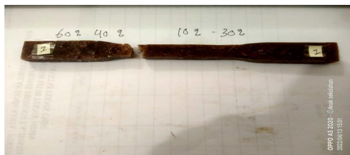
Gambar 4.3. Spesimen sesudah pengujian uji tarik komposit Resin 60:40, Serat sabut kelapa : serbuk kayu (10:30).
