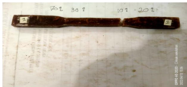
Gambar 4.9. Spesimen sesudah pengujian uji tarik komposit Resin 70:30, Serat sabut kelapa : serbuk kayu (10:20)
