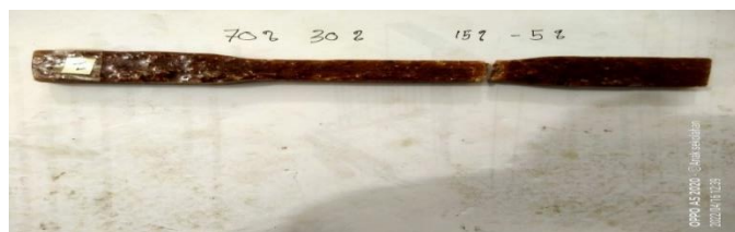
Gambar 4.13. Spesimen sesudah pengujian uji tarik komposit Resin 70:30, Serat sabut kelapa : serbuk kayu (15:15)
