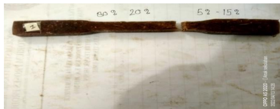
Gambar 4.15. Spesimen sesudah pengujian uji tarik komposit Resin 80:20, Serat sabut kelapa : serbuk kayu (5:15).
