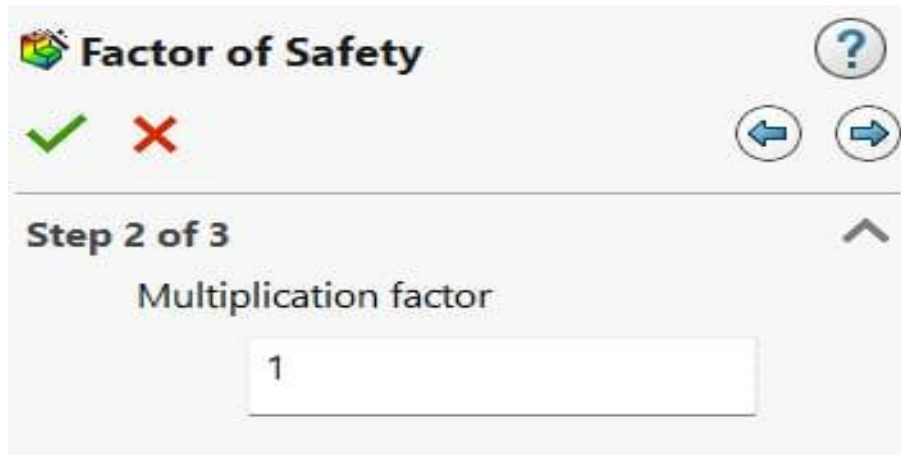
Gambar 4.17 Tampilan pemilihan factor safety seting dengan memberi nilai 1 pada software solidwork 2021
