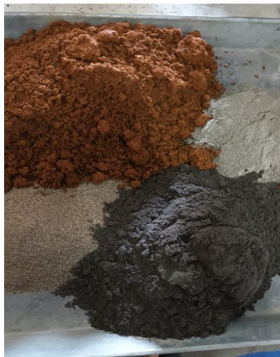
Gambar L19. Bata Variasi Campuran Tanah Merah,Pasir,Semen,AAT
