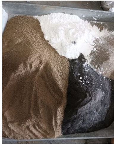
Gambar L18. Bata Variasi Campuran Tanah Galong,Pasir,Kapur,AAT
