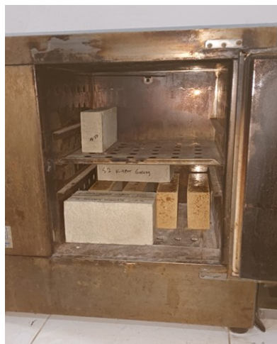
Gambar L20. Uji Penyerapan Air Bata
