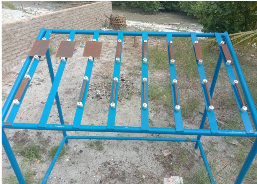
Gambar 2.4 Spesimen yang diekspos diatas rak pengujian.
