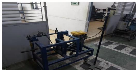
Gambar 3.8 Mesin *Brake Dynamometer*
