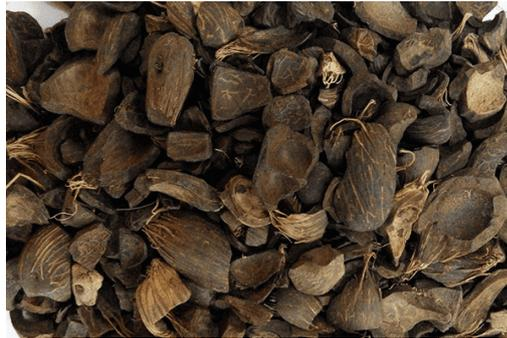
Gambar 2.4 Cangkang Kelapa Sawit
