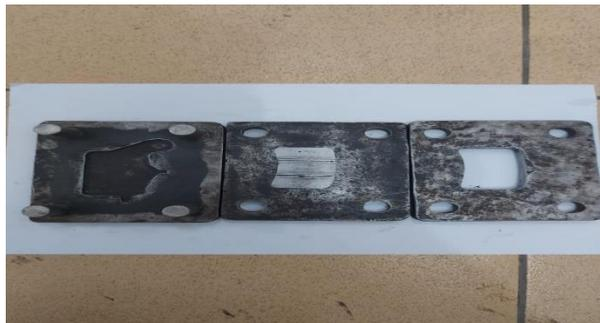
Gambar 3.10 Cetakan atau Mal Kampas Rem
