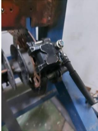
Gambar 3.21 Letak Caliper Rem
