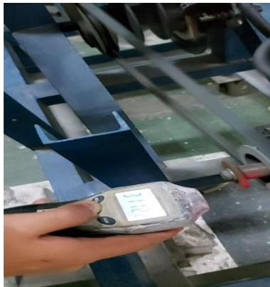
Gambar 3.22 Mengukur RPM Menggunakan *Tachometer*
