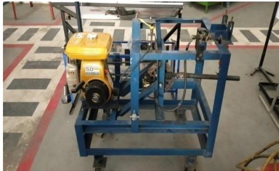
Gambar 3.19 Mesin *Brake Dynamometer*
