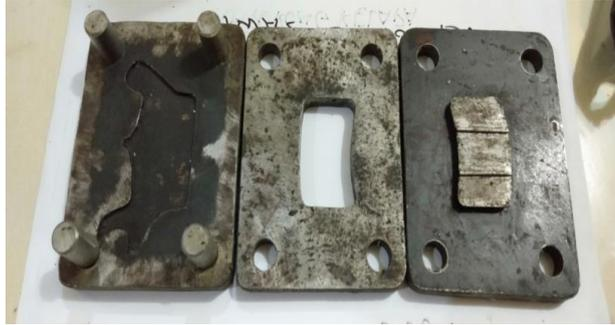
Gambar 3.3 Cetakan Atau Mal Kampas Rem
