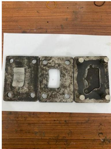
Gambar 4.1 Cetakan atau Mal
