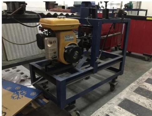
Gambar 3.2 Mesin Brake Dynamometer
