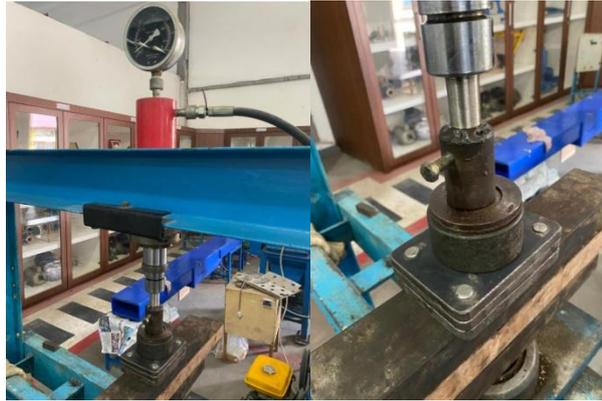
Gambar 4.21 Proses Kompaksi atau Penekanan
