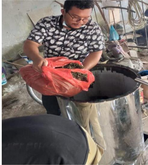
Gambar 3.20 Proses Penyulingan Daun Nilam
