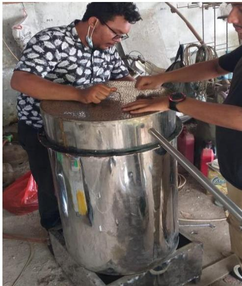
Gambar 3.19 Memasang Saringan Pada Ketel
