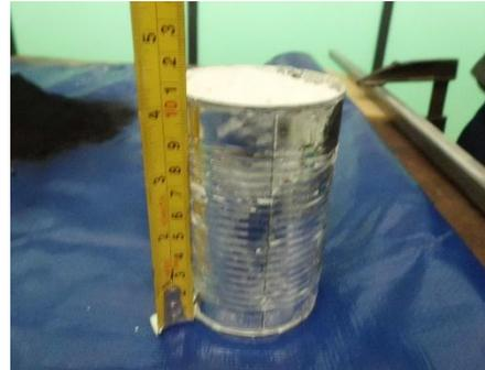
**Tabung Ukur untuk Komposisi Pencampuran Material Aditif**
