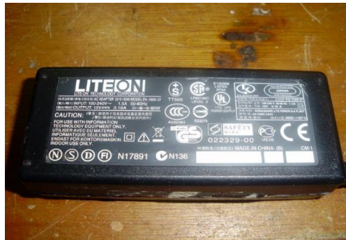
Gambar 4.5. Spesifikasi Charger Laptop
