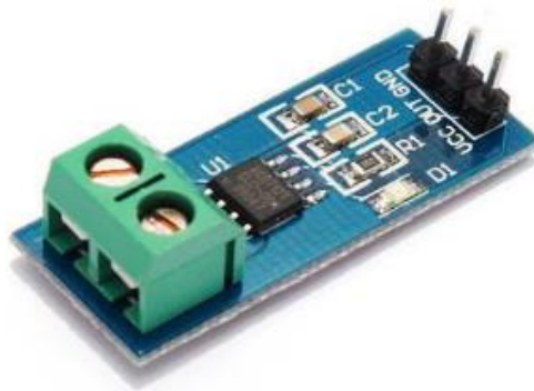
Gambar 2.9. Ilustrasi Sensor ACS 712
