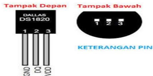
Gambar 2.7 Bentuk Fisik Sensor Suhu DS18B20
