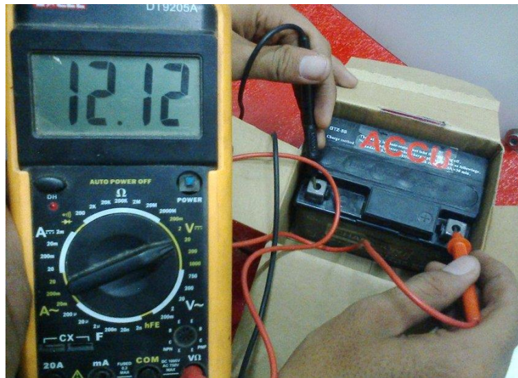
Gambar 4.3 Pengukuran Tegangan Pada Baterai Yang Disuplai oleh Turbin Angin
