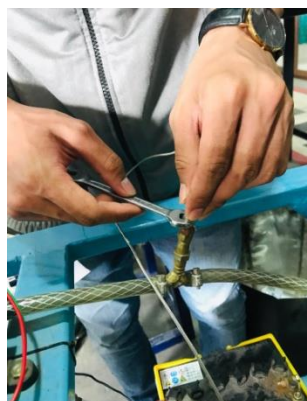
Gambar 4.11. Pemasangan sensor menuju radiator
