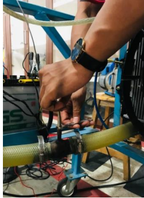
Gambar 4.12. Peasangan sensor ke saluran buang dari radiator
