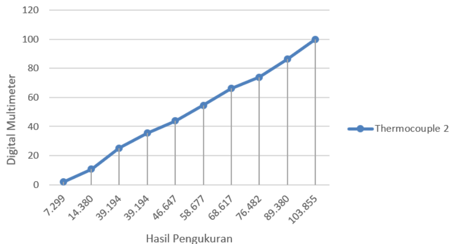
Gambar 4.26 Grafik Perbandingan Suhu Pada Digital Multimeter Dengan Hasil Pengukuran Suhu Pada Sensor Themocouple 2
