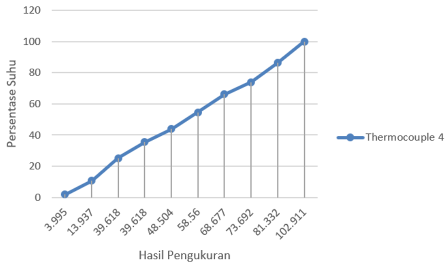
Gambar 4.30 Grafik Perbandingan Suhu Pada Digital Multimeter Dengan Hasil Pengukuran Suhu Pada Sensor Themocouple 4
