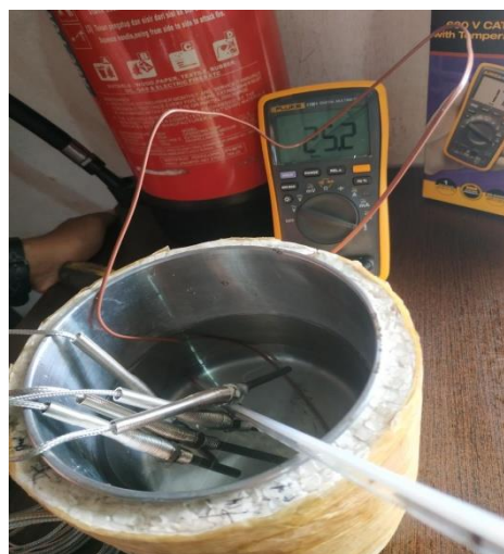
Gambar 2.17. Kalibrasi dengan alat ukur thermodigital
