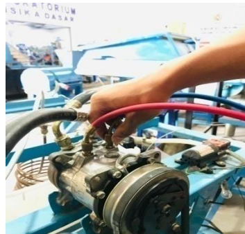
Gambar 4.13. Memasang selang manifold
