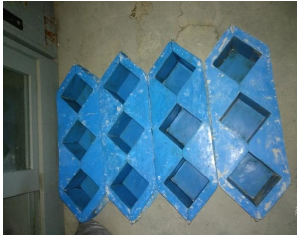
Gambar 3.2: Cetakan Beton Khubus.
