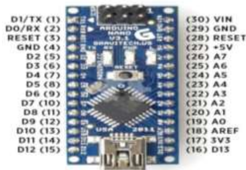
Gambar 2. 6 Pin Konfigurasi Arduino Nano (Sumber : (Ii & Pustaka, n.d.)
