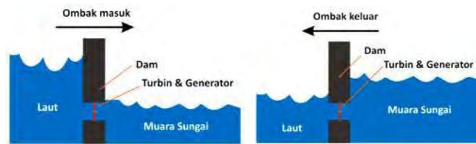
Gambar 2. 3 Bendungan pasang surut
