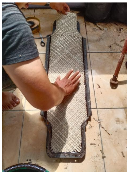
Gambar 3.14. Letakan Serat pandan duri ke cetakan
