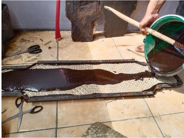
Gambar 3.17. Tuangkan campuran resin
