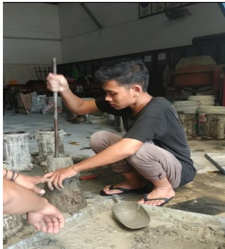
Lampiran 29: Proses perojokan adukan beton.
