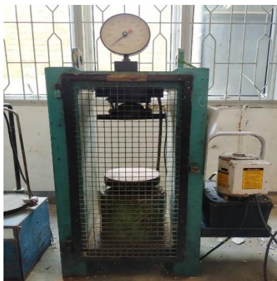
Lampiran 36: Proses pengujian kuat tarik belah beton.
