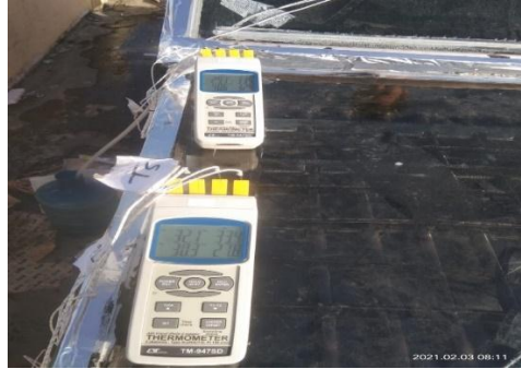
Pemasangan Thermocouple Pada Alat Desalinasi
