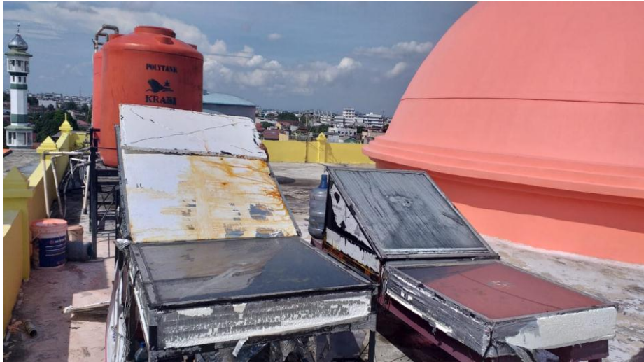
Gambar 4.1 Rancangan alat desalinasi dengan menggunakan penutup dan tanpa menggunakan penutup.
