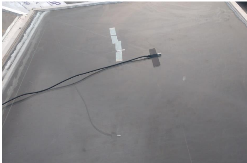
Gambar 3.8. Sensor Temperatur DS18B20
