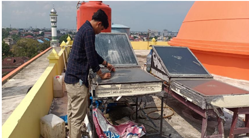
Gambar 4.3 Memeriksa alat pengukur temperatur dan memeriksa kebocoran pada alat desalinasi.
