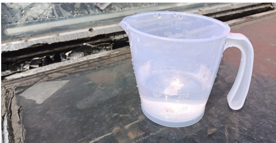
Gambar 4.23 pengukuran air bersih hasil pengujian desalinasi.
