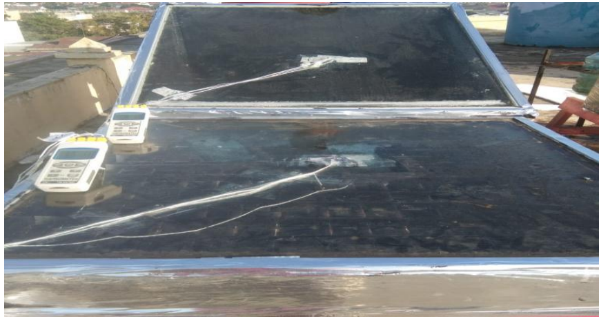
Gambar 4.9 Pengambilan data menggunakan thermometer dan thermokopel
