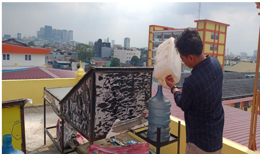
Gambar 4.4 Pengisian air laut kedalam tangki penampungan air laut dan mengalirkan air laut.
