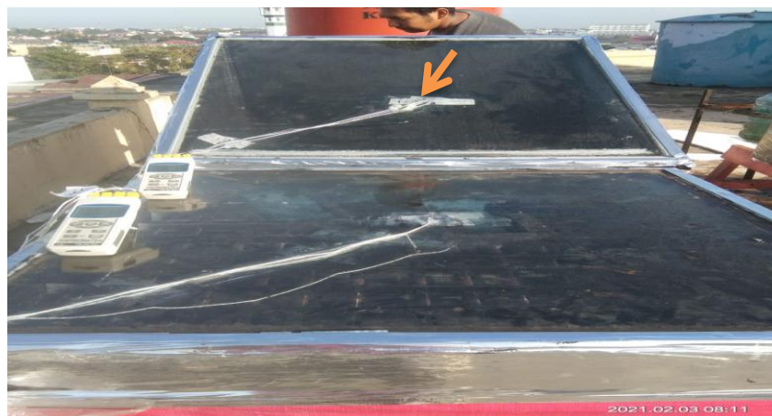
Gambar 4.6 Posisi thermokopel untuk membaca temperatur kaca pada sisi luar dan dalam
