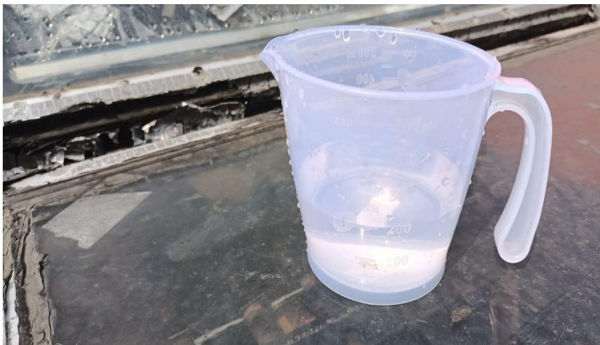
Gambar 4.8 Air tawar hasil desalinasi diukur menggunakan gelas ukur.
