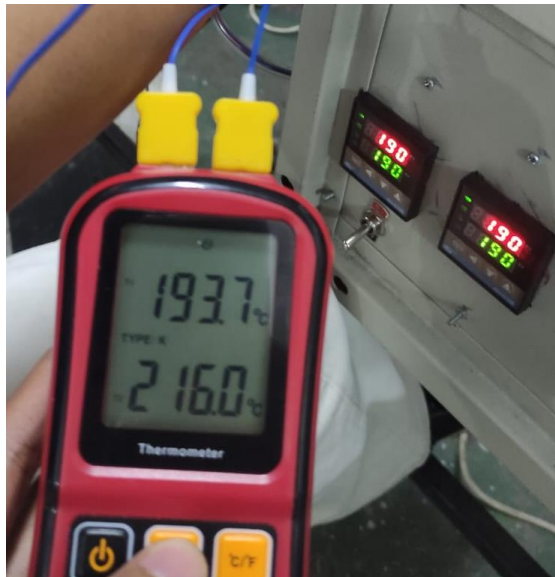
Gambar 4.42 Perbandingan suhu heater 1 dan 2
