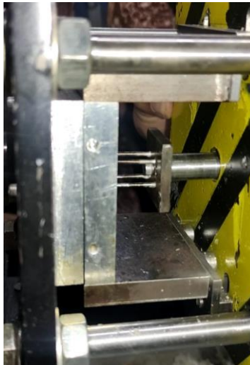
Gambar 3.24 Cetakan yang berisi lelehan plastik
