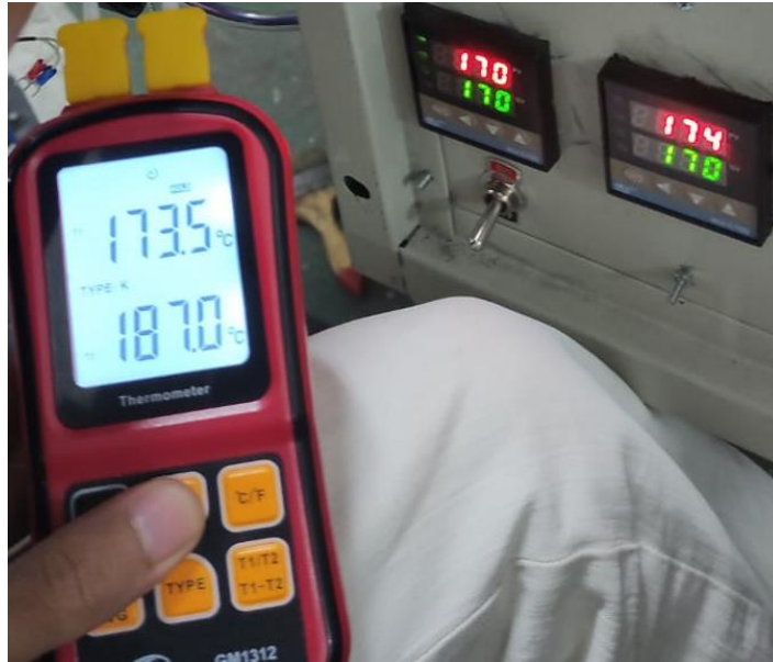
Gambar 4.27 Perbandingan suhu heater 1 dan 2
