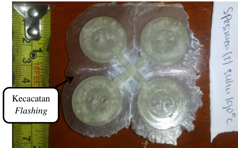
Gambar 4.44 Spesimen pengujian kedua suhu 190°C
