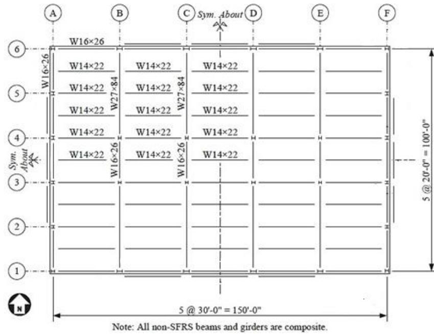
Gambar 3.2: Denah Rangka Lantai Tipikal 4 Lantai dan 8 lantai
