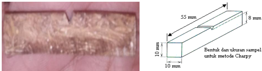
Gambar 4.3. Gambar Spesimen Uji Impact
