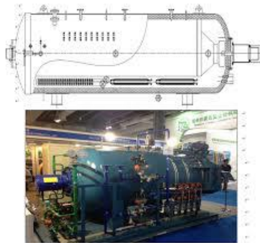
Gambar 2.12. Cetakan Autoklaf tekanan (Ananonim :2013)
