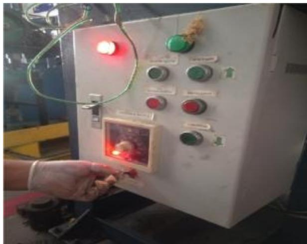
Gambar 3.18. Saklar *thermocouple*
