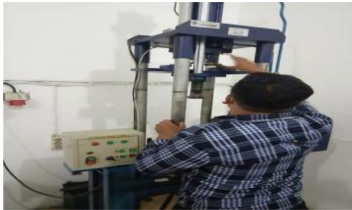
Gambar 3.31 meletakkan specimen pada tumpuan
