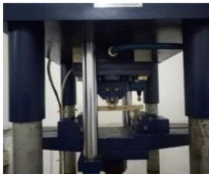
Gambar.3.32. Proses pengujian Lentur (Dokumen pribadi)
