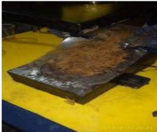
Gambar 3.28. Mengangkat bet komposit dari cetakan
