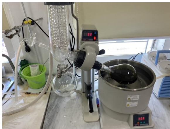
Evaporator Ekstrak Bidara Laut
