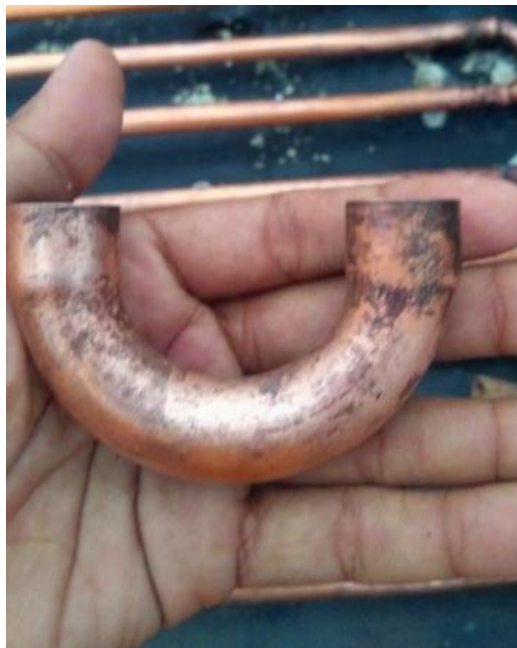
Gambar 3.6. Sambungan Pipa Tembaga
